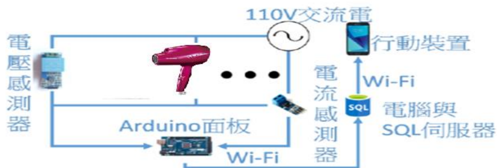
圖 2 智慧居家電力監測架構圖
