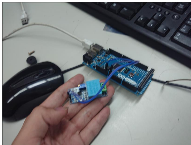
圖 3. Arduino 連接 ZMPT101B
